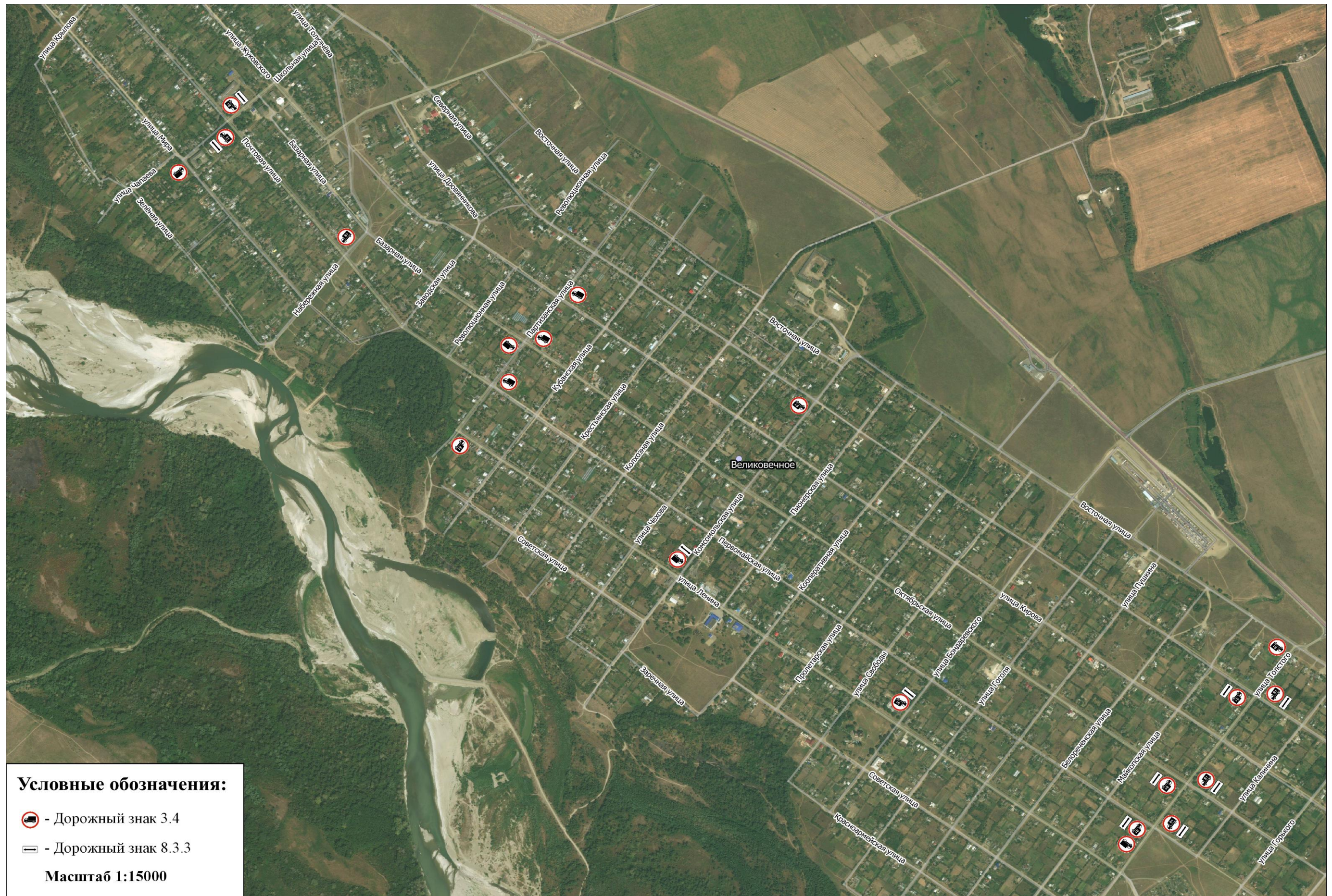
Рисунок И.21 – Схема расположения знаков 3.4 «Запрет движения грузового транспорта» в Белореченском районе
